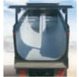
Caja volcadora de tipo elíptico.
